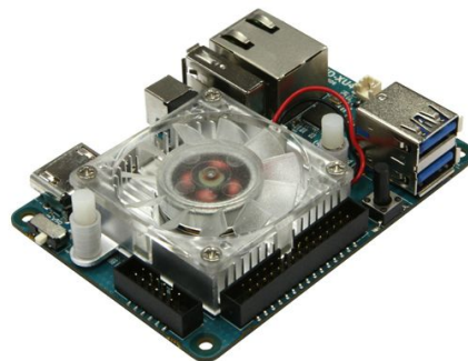
Figure 5: Odroid XU4 SBC
